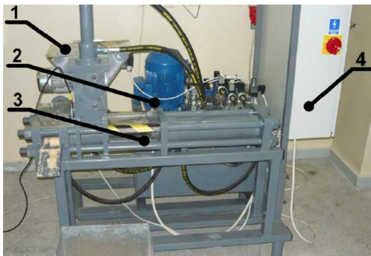
Rys. 1. Zdjęcie poglądowe rozmieszczenia elementów brykietarki, gdzie: 1 – zbiornik zasypowy połączony z blokiem prasującym; 2 – zasilacz hydrauliczny; 3 – blok prasujący; 4 – układ sterujący (szafa sterująca)
