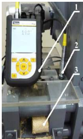
Rys. 8. Sposób podłączenia czujnika temperatury do bloku prasującego, gdzie: 1 – przyrząd pomiarowy Serviceman Plus®, 2 – czujnik pomiarowy SCT-150-04-02, 3 – gotowy wyrób w postaci brykietu
