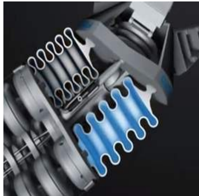
Rys. 4. Pozycjonowanie chwytaka poprzez wtłaczanie powietrza do siłowników [5]
