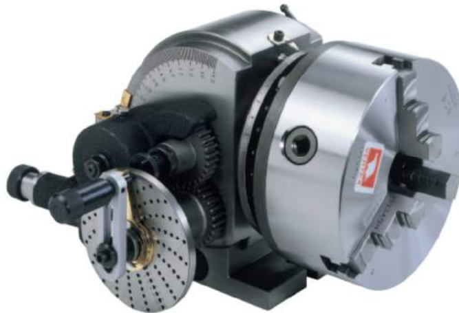
Rys. 2. Przykład podzielnicy; podzielnica uniwersalna Vertex BS-2-J IS-BS2 wraz z uchwytem trójszczękowym [7]
