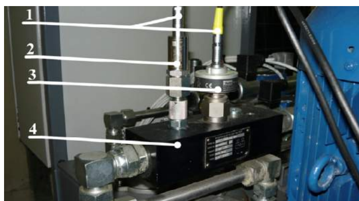
Rys. 7. Sposób podłączenia czujników do turbiny, gdzie: 1 – kable SCK-102-05-12, 2 – czujnik SCP-400-74-02, 3 – czujnik przepływu (60 l/min), 4 – turbinowy miernik przepływu SCFT-060-02-02
