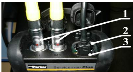
Rys. 6. Sposób podłączenia poszczególnych elementów, gdzie: 1 – kable SCK-102-05-12 podłączone do dwóch równoległych wejść, 2 – pamięć przenośna USB (1 GB), 3 – kabel micro-USB, typ A
