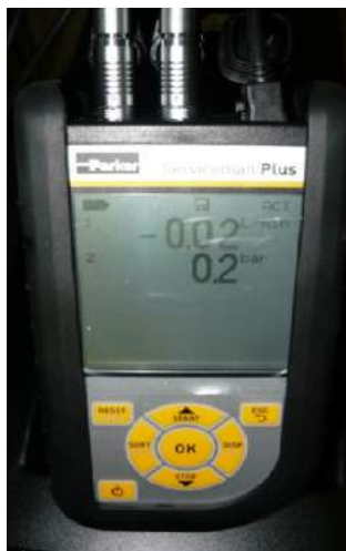
Rys. 2. Przyrząd pomiarowy Serviceman Plus® model SCM-155-0-02 firmy PARKER
