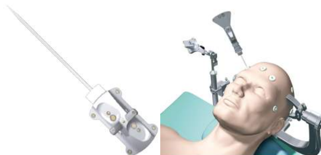
Rys. 2. Narzędzie z wbudowanymi diodami LED oraz przykładowe zastosowanie wraz z markerami przyklejonymi do skóry głowy pacjenta [8]
