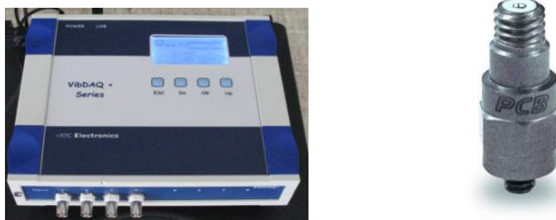
Rys. 7.2. Czterokanałowy moduł aktywizacji danych VIBDAQ+ wraz z czujnikiem
