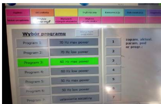
Rys. 7.22. Moduł sterowania rozdrabniarki z opcją wyboru trybu pracy
