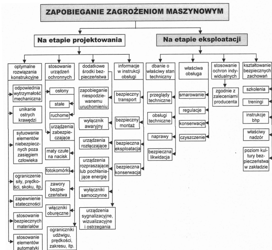
Rys. 4.2. Wybrane sposoby zapobiegania zagrożeniom maszynowym [33]
