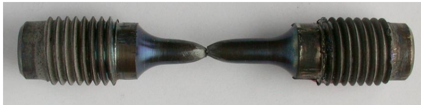
Rys. 4.1. Przykłady uszkodzenia próbek podczas prób statycznego rozciągania:
