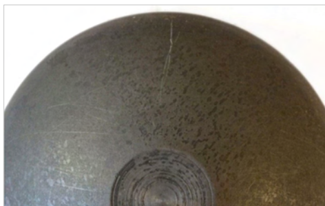
Rys. 7.23. Próbką z widocznymi śladami obróbki
