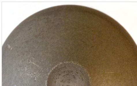
Rys. 7.24. Próbką z widocznymi śladami kawitacji
