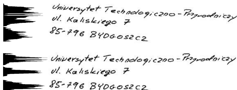
Rysunek 1.7: Przykładowy wynik działania algorytmu określającego kąt przekosu. Dla rozważanego przykładu kąt przekosu wynosi 3.1^\circ .
