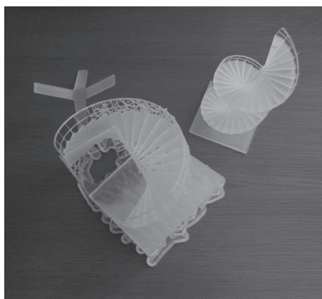
Rys. 10. Trzy przykłady drukowania 3D – ten w dole zdjęcia przed usunięciem podpór konstrukcyjnych (fot. autor)
