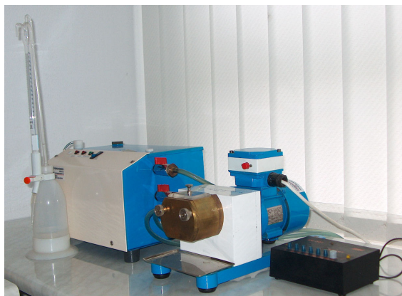
Fot. 4.3. Zestaw do przygotowywania próbek ciasta [49], miesiarka laboratoryjna MML-25, termostat o stałej nastawie, biureta, zegar sygnalizacyjny
