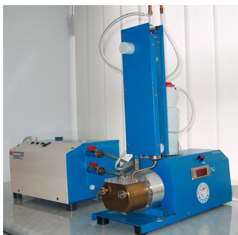
Fot. 4.2. Zestaw do pomiaru wodochłonności [49]
