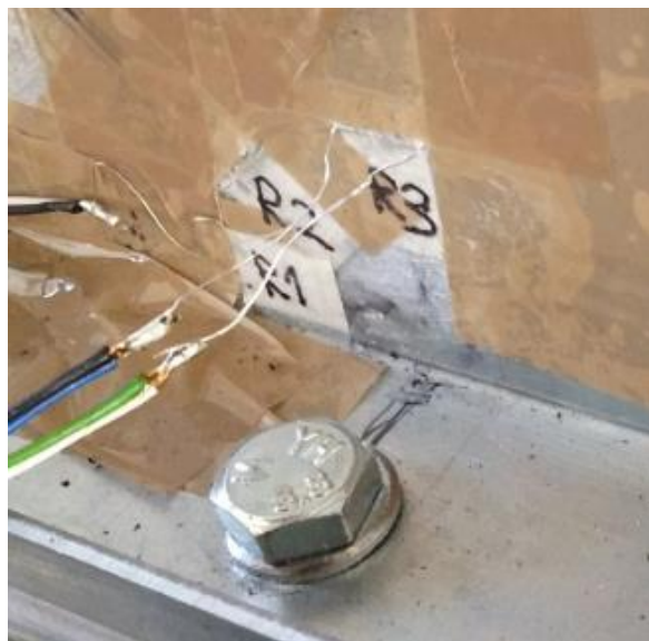
Rysunek 4. Tensometr oporowy R1-3 zamocowany na obiekcie badań
