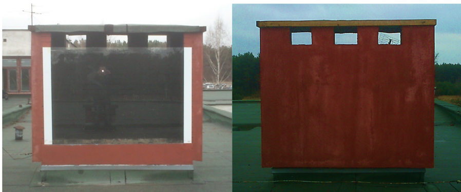
Rys. 2. Widok badanego komina słonecznego
