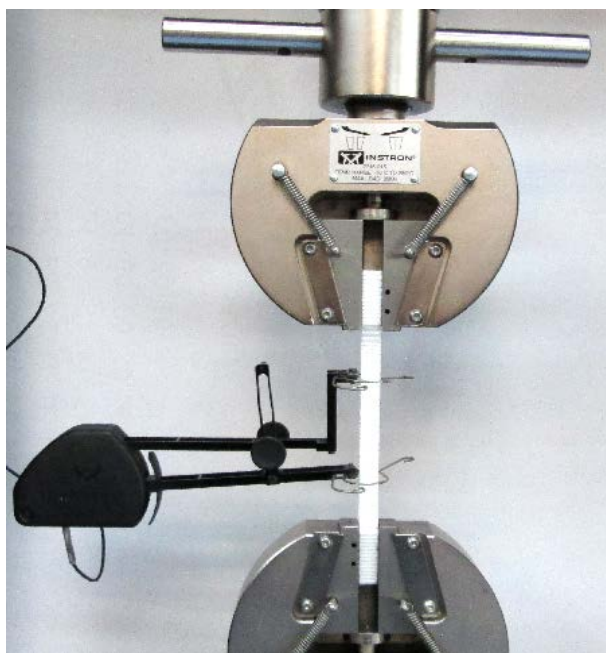
Rys. 5. Mocowanie próbki [opracowanie własne]
