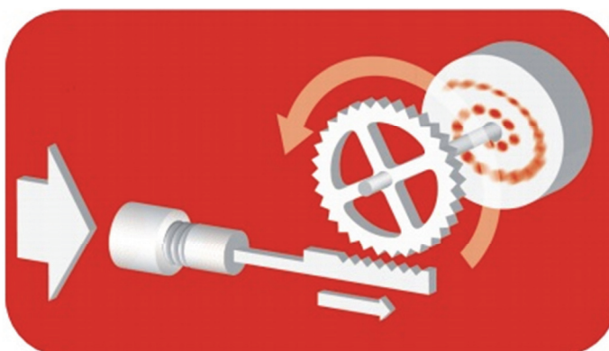
Rys. 8. Schemat działania układu mechanicznego zastosowanego w zderzaku [ http://www.epar.pl ]
