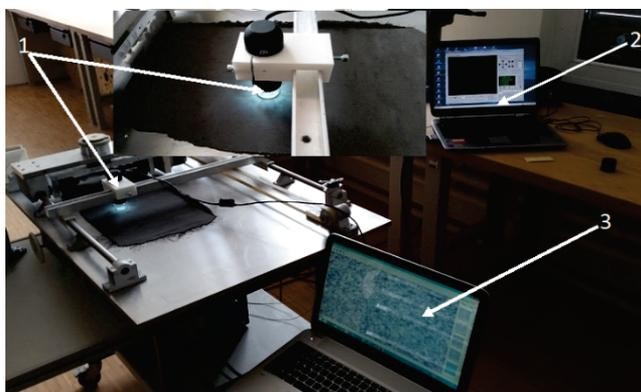
Rys. 9. Widok usytuowania kamery cyfrowej do rejestracji obrazów: 1 – kamera cyfrowa, 2 – komputer sterujący prędkościami walca i zespołu jezdnych, 3 – komputer do archiwizacji danych
