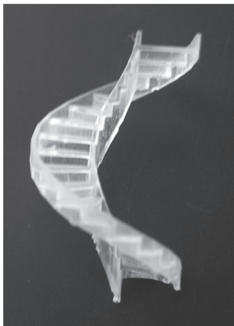
Rys. 2. Model schodów kręconych wykonany z użyciem druku stereolitograficznego (fot. autor)
