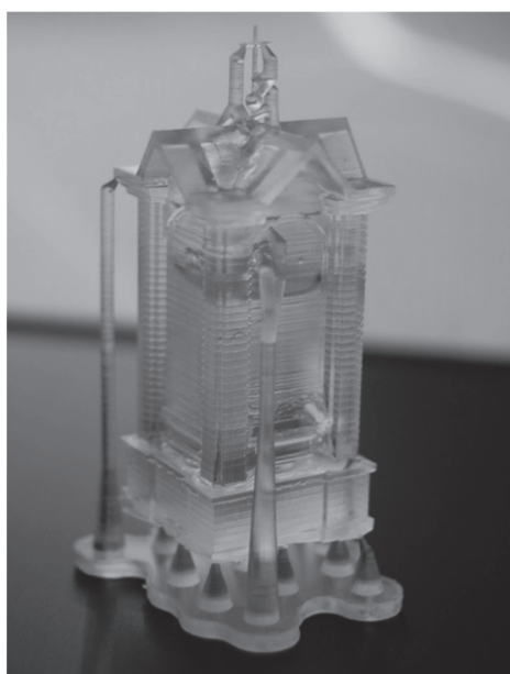
Rys. 4. Model kapliczki przydrożnej w Nowym Dworze wydrukowany na drukarce Form 2 – widok przed usunięciem podpór konstrukcyjnych (fot. autor)
