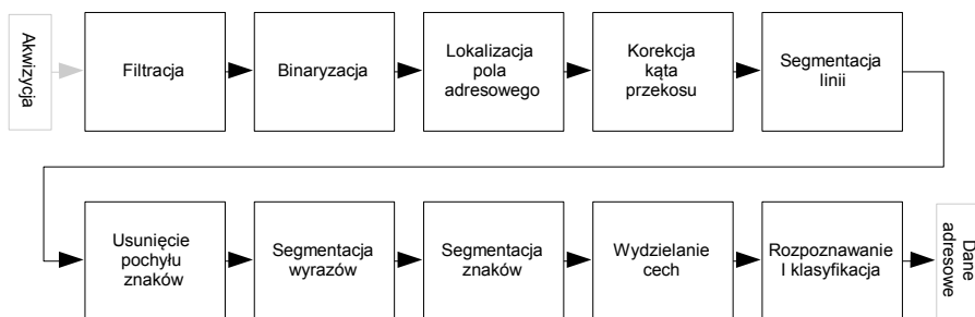
Rys. 1. Schemat automatycznego rozpoznawania danych adresowych
