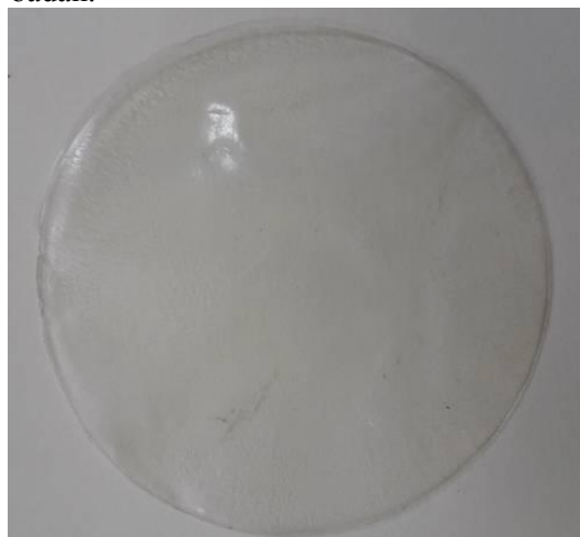
Rys. 40. Zdjęcie polimerowej membrany inkluzyjnej przed procesem transportu [zdjęcie własne].
