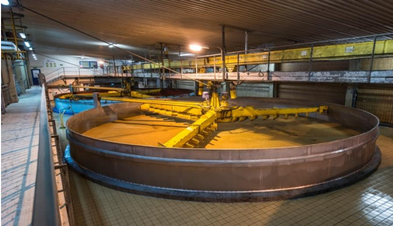
Rys. 4.1. Zamaczalnia wraz z maszynami i urządzeniami realizującymi proces zamaczania jęczmienia
