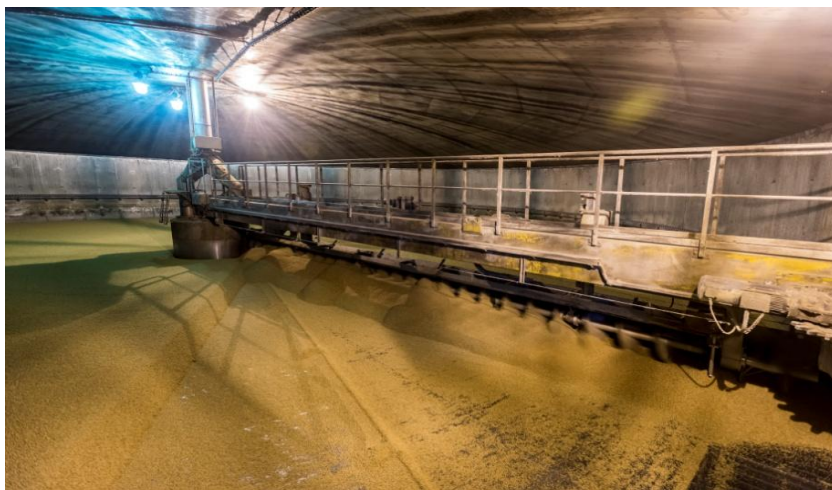
Rys. 4.3. Suszarnia słodu wraz z maszyną za- i wyładowniczą podczas załadunku kolejnej partii produkcyjnej
