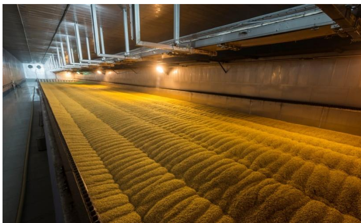
Rys. 4.2. Skrzynia Saladina wraz z maszynami i urządzeniami realizującymi proces kiełkowania jęczmienia
