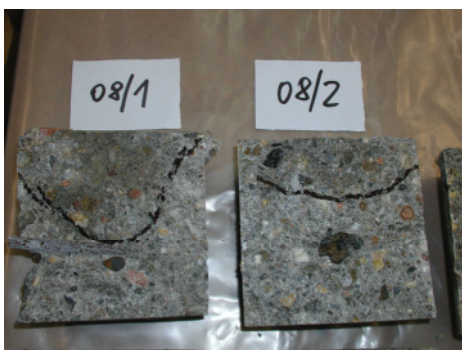
Rys. 14. Oznaczenie głębokości wnikania wody
