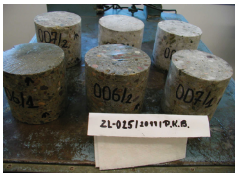
Rys. 13. Próbkę do badań wytrzymałości na ściskanie
