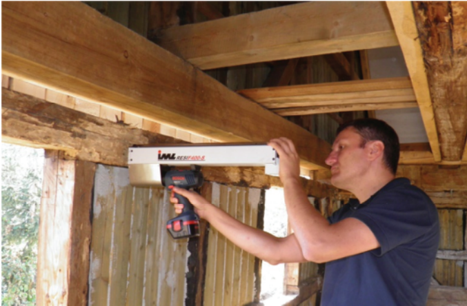
Rys. 10. Pomiar z użyciem rezystografu
