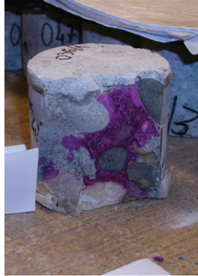
Rys. 12. Głębokość karbonatyzacji Fig. 12. Sample after carbonation test
