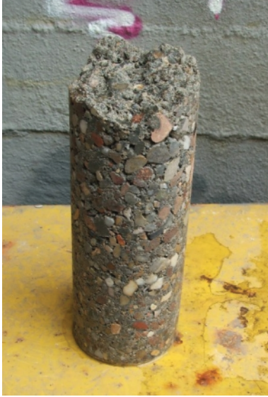
Rys. 11. Odwiert próbki betonu Fig. 11. Sample of concrete core
