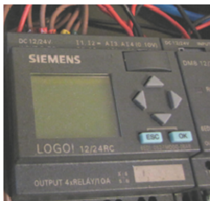
Rys. 4.22. Sterownik LOGO! – rozmieszczenie przycisków
