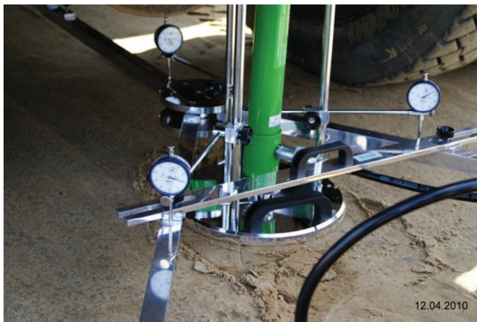
Fot. 1. Aparat VSS-3a w trakcie wykonywania badania
