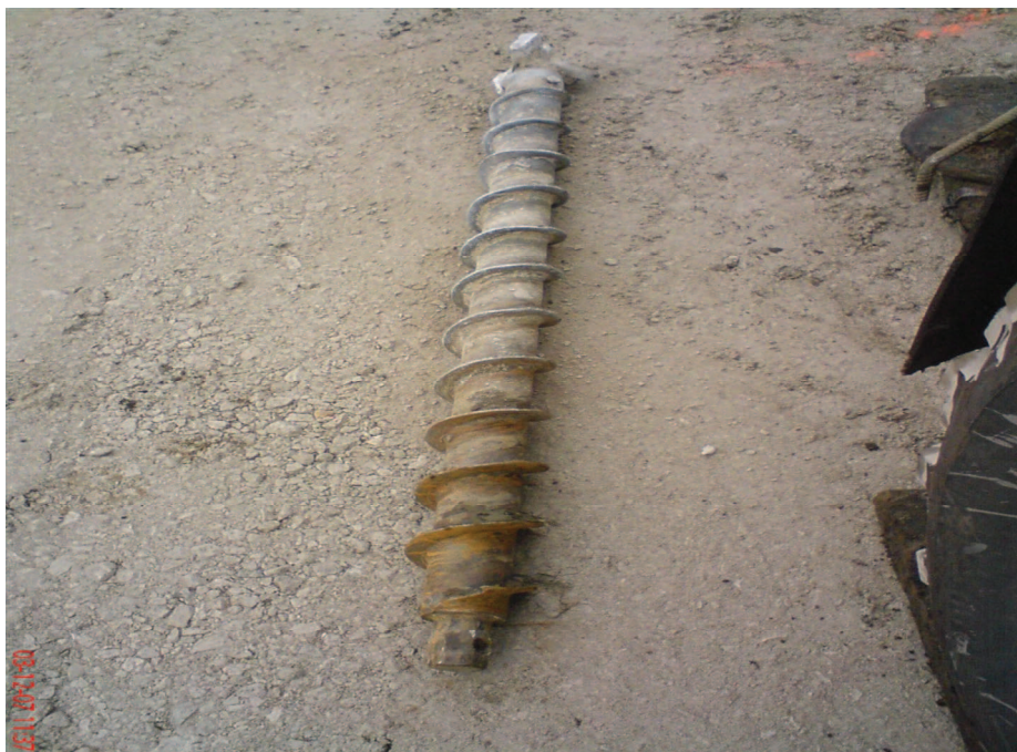
Fot. 17. Widok świdra spiralnego. Widoczny zakres spenetrowanej głębokości na świdrze
