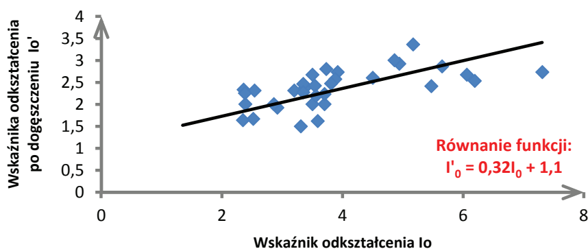
Rys. 47. Zmiany wartości wskaźnika odkształcenia po dogęszczeniu jedną warstwą zasypową
