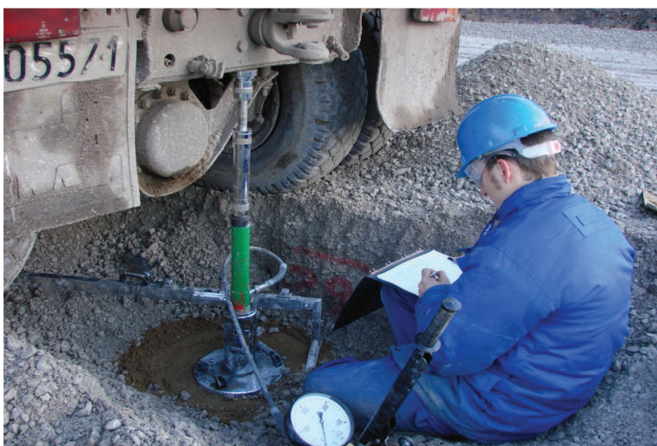
Fot. 13. Widok poligonu – etap III. Badanie warstwy 28 badanie VSS poziom – 0,30 m
