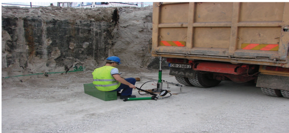
Fot. 9. Widok poligonu – etap II. Badanie VSS na warstwie wierzchniej – badanie pierwotne
