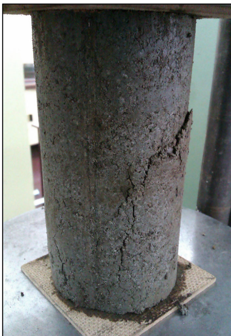
Rys. 47. Sposób zniszczenia ściskanych próbek cylindrycznych: a) kruche ściecie, b) zniekształcenie próbki bez wyraźnej płaszczyzny ścinania
