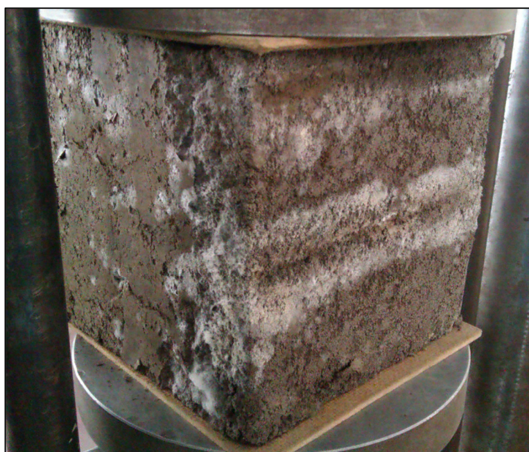
Rys. 21. Próbkę sześcienną kompozytu K18 o naturalnej zawartości substancji organicznej pokrytą pleśnią po 28 dniach dojrzewania
