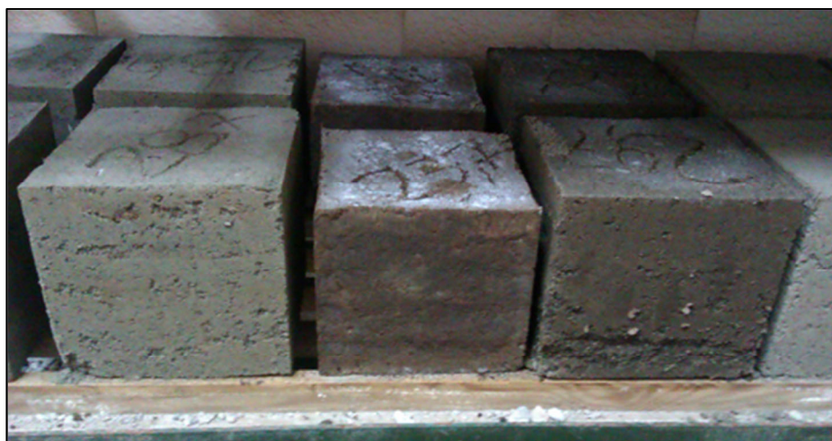
Rys. 22. Próbką sześcienna kompozytu K16 o naturalnej zawartości substancji organicznej pokryta pleśnią po 7 dniach dojrzewania.
