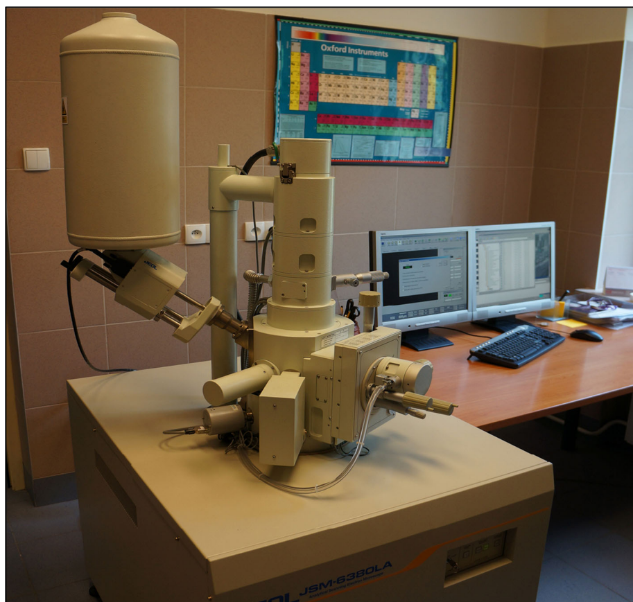
Rys. 60. Skaningowy mikroskop elektronowy firmy JOEL, typ JSM-6380 LA sprzężony z mikrosondą elektronową EDS
