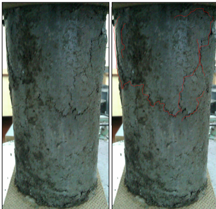
Rys. 56. Zniszczone próbki kompozytu K3 bezpośrednio po badaniach wytrzymałościowych
