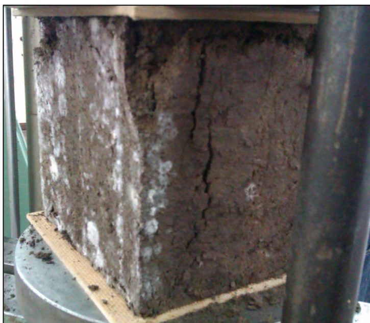
Rys. 20. Próbkę sześcienną kompozytu K16 o naturalnej zawartości substancji organicznej pokrytą pleśnią po 28 dniach dojrzewania
