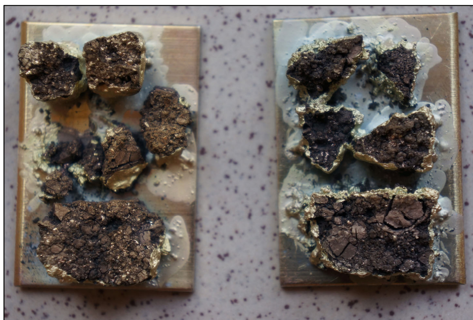
Rys. 62. Napyłone złotem próbki kompozytu przygotowane do badań w świetle elektronów wtórnych SEI
