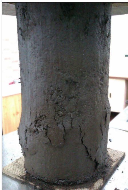
Rys. 47. Sposób zniszczenia ściskanych próbek cylindrycznych: a) kruche ściecie, b) zniekształcenie próbki bez wyraźnej płaszczyzny ścinania
