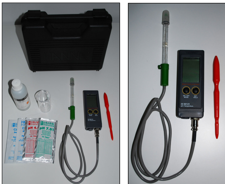
Rys. 48. Miernik pH firmy Hanna Instruments, model HI 99121 zaopatrzony w elektrodę kombinowaną model HI 1292D
