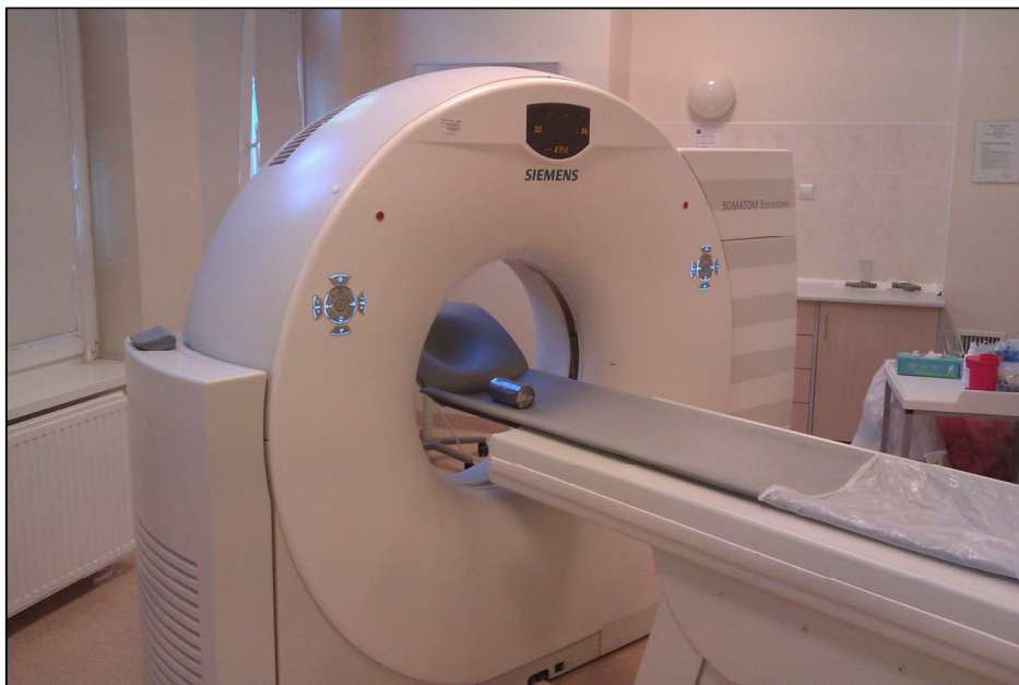
Rys. 55. 16-rzędowy spiralny tomograf komputerowy firmy Siemens – model Somatom Emotion – 16 podczas badania próbek cylindrycznych
