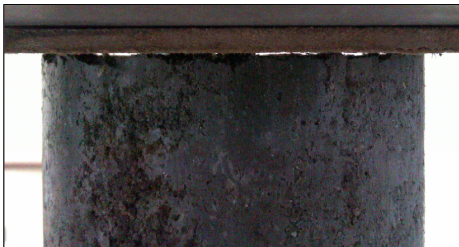
Rys. 19. Widoczne nierówności podstaw próbek kompozytu na styku z płytą dociskową
