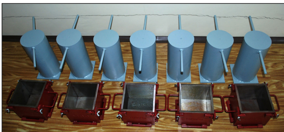
Rys. 16. Zastosowane do badań formy sześciennie o wymiarach 150x150x150 mm i odważniki
