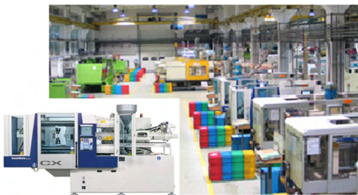
Rys. 7.7. Widok hali technologicznej wraz z modelem użytej wtryskarki Krauss Maffei 50 CX, na której przeprowadzono eksperyment w warunkach przemysłowych (Graform Bydgoszcz)
