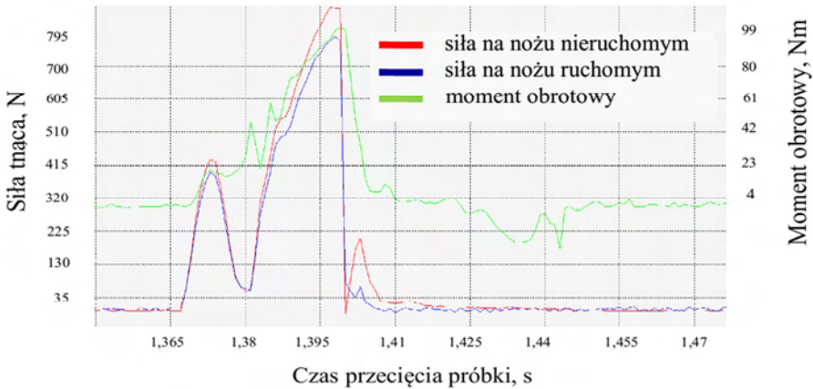
Rys. 5.3. Wpływ pochylenia krawędzi tnących 2\lambda = 13,5^\circ dla przebiegów zmian siły i momentu obrotowego podczas cięcia próbek: a) z litego PP oraz b) PP o zawartości 2% poroforu uzyskanych bez stosowania docisku; pozostałe parametry: prędkość obwodowa noży 0,3 \text{ m}\cdot\text{s}^{-1} , kąty ostrza \beta_r = 60^\circ i \beta_s = 60^\circ , szczelina międzyżoźowa 0,06 \text{ mm}
