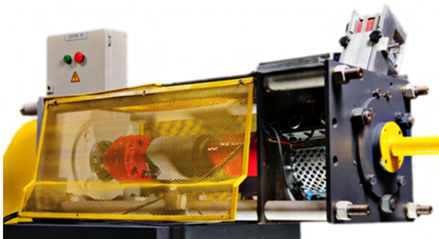
Rys. 3.1. Stanowisko przygotowane do realizacji badań cięcia i rozdrabniania: a) widok ogólny z węzłem podawania, b) widok komory roboczej z założonym sitem (UTP Bydgoszcz)
