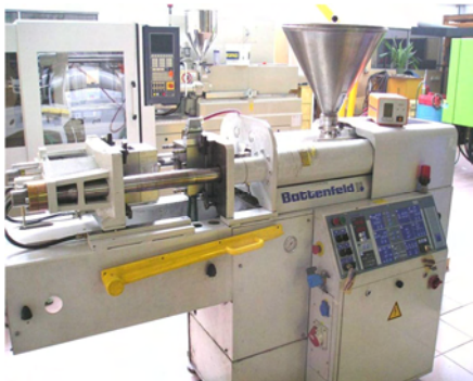
Rys. 7.3. Stanowisko do wykonania próbek z recyklatów porowatych: a) wtryskarka Battenfeld 350 Plus, b) modułowa forma 2-gniazdowa do wytwarzania próbek badawczych z systemem gorąco kanałowym (UTP Bydgoszcz)
