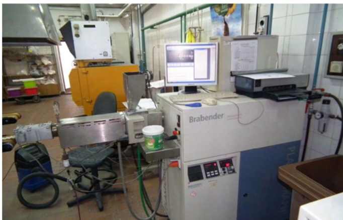
Rys. 7.4. Plastograf Brabendera użyty do wytłaczania recyklatów porowatych – Prolab Włocławek
