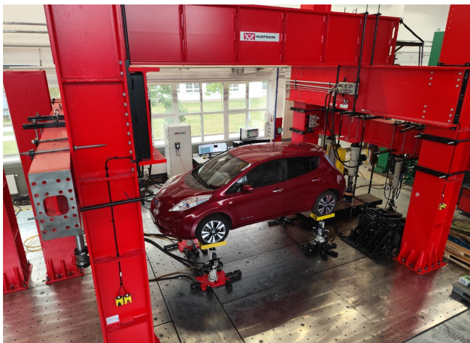
System do badania struktur wielkogabarytowych wyposażony w 18 niezależnie sterowanych według dowolnego programu serwocylindrów hydraulicznych (Instron Structural Testing System) o nominalnym obciążeniu dynamicznym od \pm 10 kN do \pm 1000 kN
