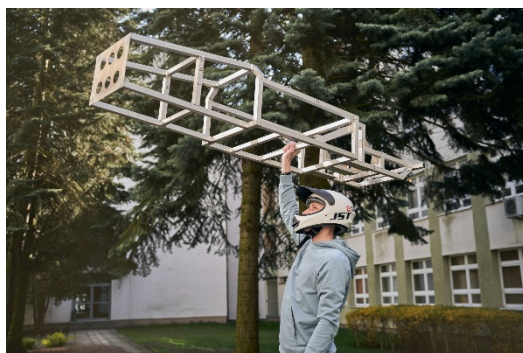
Rama bolidu elektrycznego – projekt realizowany przez studentów koła naukowego
