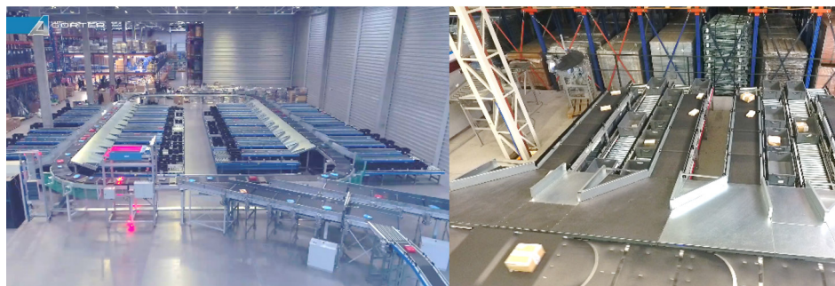
System cross-belt do zautomatyzowanego sortowania ładunków jednostkowych metodą dwuetapową
