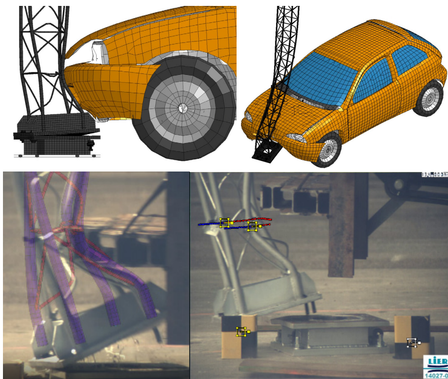
Modelowanie numeryczne oraz testy zderzeniowe pojazdów z infrastrukturą drogową
