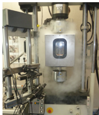
Indukcyjny system grzania próbek oraz komora kriogeniczna
