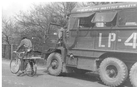
Badania zmęczeniowe roweru i motocykla w warunkach eksploatacyjnych
