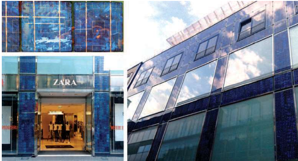
Rys. 2. Budynek firmy ZARA w Kolonii: a) polikrystaliczne ogniwa krzemowe, b) okładzina ścienna, c) fasada wentylowana, fot. A. Budzyńska
