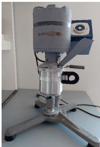
Rys. 3.24. Stein breakage tester w laboratorium Physical Properties and Grain Characterization w Uniwersytecie Purdue (materiały własne)
