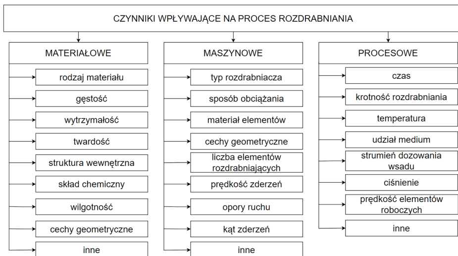
Rys. 4.1. Klasyfikacja czynników wpływających na ocenę maszynowego rozdrabniania ziaren biomasy (opracowanie własne na podstawie [155, 199])
