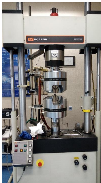
Rys. 5.14. Stanowisko badawcze do wykonywania testów statycznych i zmęczeniowych: a) widok maszyny wytrzymałościowej Instron 8502, b) widok próbki badawczej w uchwytach maszyny z zamontowanym ekstensometrem
