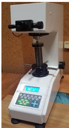
Rys. 5.41. Twardościomierz HUATEC HV-10: a) widok przyrządu, b) widok próbki podczas badań
