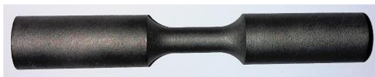
Rys. 5.6. Postać fizyczna próbki do badań w warunkach obciążeń statycznych i zmiennych wykonanych technologią DMLS
