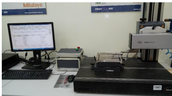
Rys. 5.13. Stanowisko do pomiaru chropowatości powierzchni Mahr MarSurf GD 120
