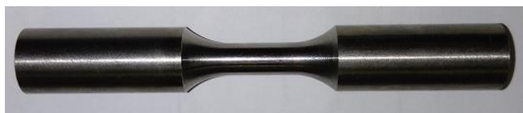
Rys. 5.5. Postać fizyczna próbki do badań w warunkach obciążeń statycznych i zmiennych wykonanych z pręta ciągnionego
