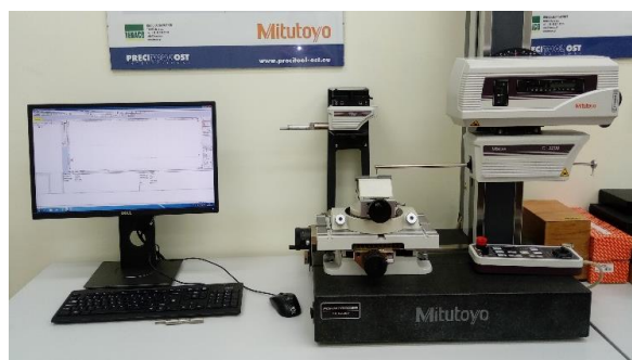
Rys. 5.8. Stanowisko do pomiarów geometrycznych Mitutoyo Formtracer SV-C3200
