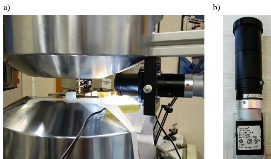
Rys. 5.19. Stanowisko badawcze do badania odkształceń: a) widok zamontowanej próbki badawczej w uchwytach maszyny z zamontowanym ekstensometrem oraz kamerą, b) kamera BASLER acA4024-8gm do pomiaru odkształcenia
