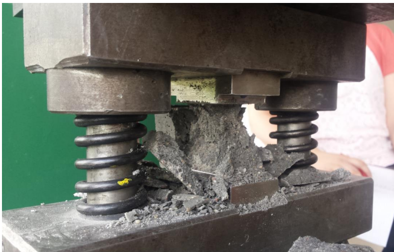
Rysunek 5.5. Widok zniszczonej w maszynie wytrzymałościowej próbki
