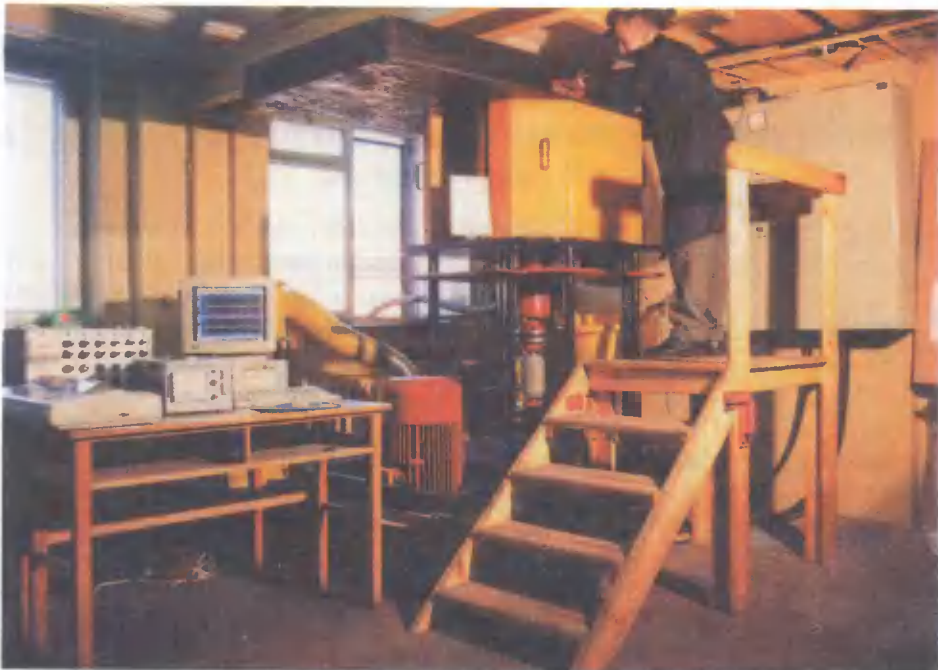
Fot.1. Uniwersalne stanowisko badawcze procesu aglomerowania cyklicznego (schemat ideowy – rys.20 i 21), realizujące wszystkie procesy wyszczególnione w kolumnach tab.VI, również w otoczeniu gazu obojętnego (np. argonu)
