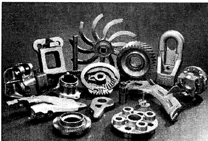
Rys. 11. Odlewy części maszyn wykonane z żeliwa CADI [29]
