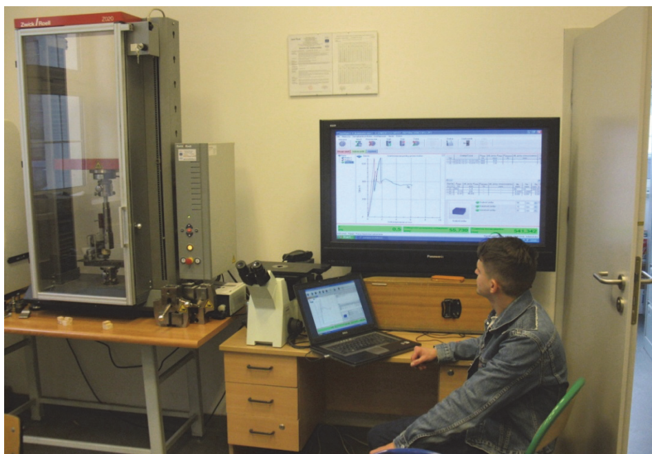
Rys. 1. Stanowisko do badań wytrzymałościowych próbek śliwy i gruszy na maszynie Zwick Roell w specjalistycznym laboratorium Bielskiego Centrum Kształcenia Ustawicznego i Praktycznego
