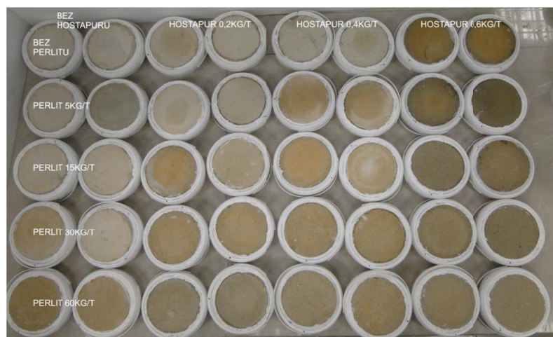
Rys. 9. Zestaw próbek przeznaczonych do badań zdolności magazynowania soli po 8 dniach nasączenia roztworem soli
