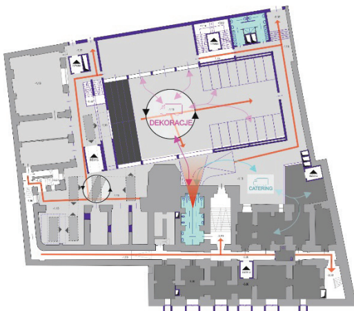
Rys. 17. Podziemie teatru z zapleczem magazynowym technicznym i warsztatowym obsługi wydarzeń scenicznych [Ibidem]
