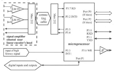
Fig. 3. Simplified electronic diagram of measurement-control module with attached capacitive linear encoder Rys. 3. Uproszczony schemat elektroniczny modułu pomiarowo-kontrolnego z liniowym enkoderem pojemnościowym
