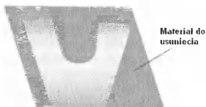
Rys. 2. Materiał usunięty podczas toczenia kształtującego [4]
