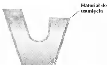
Rys. 3. Materiał usunięty podczas toczenia wykończeniowego [4]
