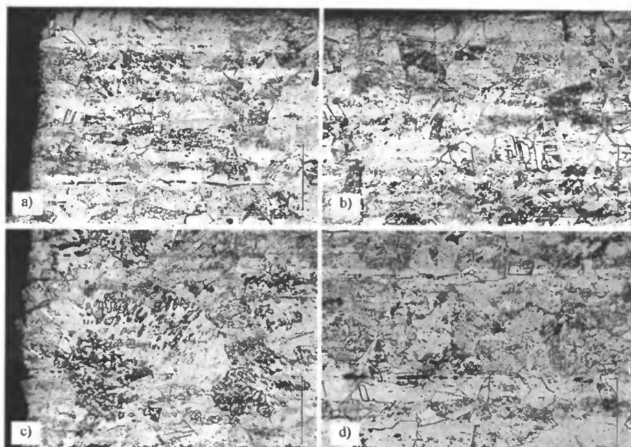
Rys. 3. Mikrostruktura stali próbki A, pochodząca z miejsca: 1 – a), 3 – b), 2 – c) i 4 – d) (powiększenie 130 \times , trawiono odczynnikiem Mi16Fe)
