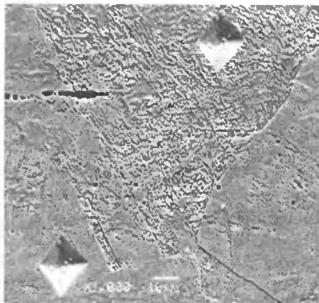
Rys. 7. Pomiary mikrotwardości w ziarnie austenitu z martenzytem i bez niego na próbce B (trawiono odczynnikiem \text{NiSO}_4 (SEM))
